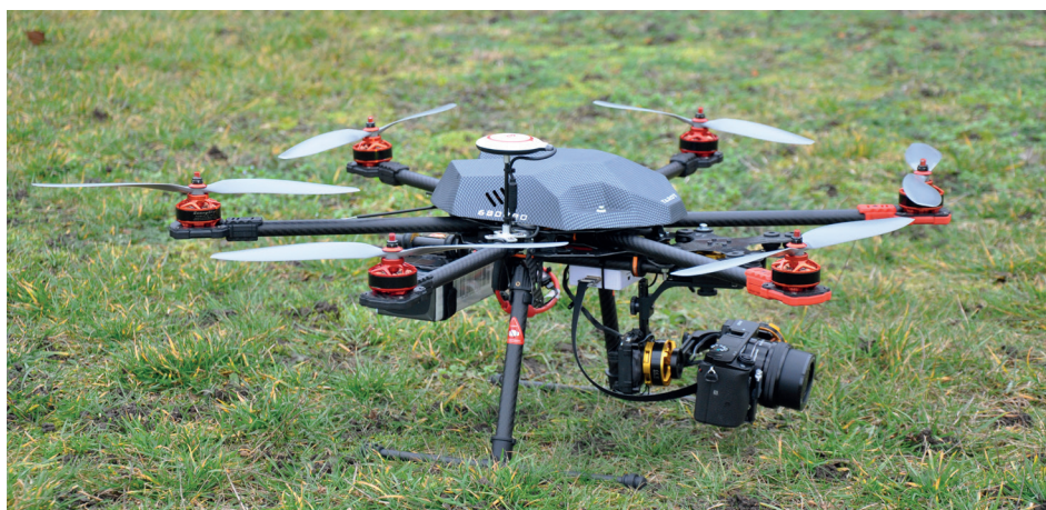
Obr. 1. Hexakoptéra TAROT 690 s fotoaparátem Sony Alpha 6000.
